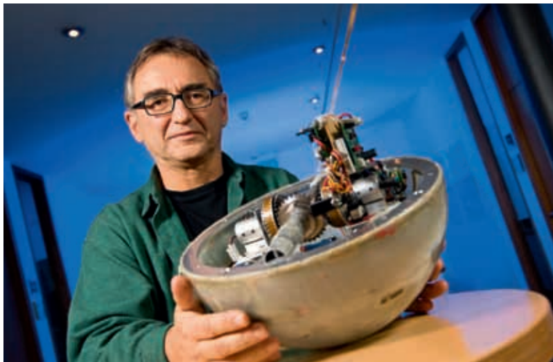
Ein Ball soll rollen lernen: Diesen Kugelroboter hat der Leipziger Künstler Julius Popp entworfen. Elektromotoren verschieben in seinem Inneren Gewichte und stoßen ihn so an. Dank des Gehirns von Ralf Der und Nihat Ay kann er sich in immer komplexere Bewegungsmuster vortasten.
